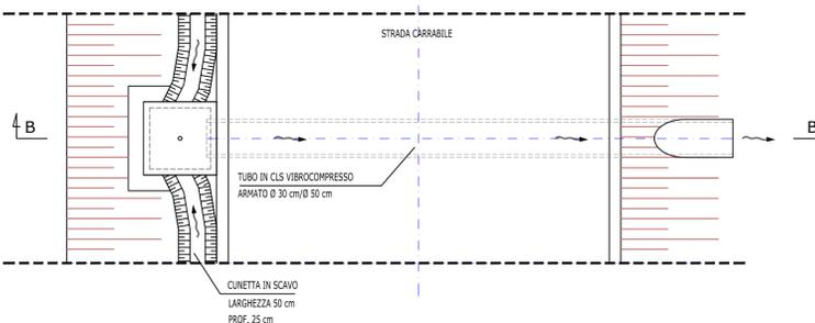
SEZIONE TIPO CON POZZETTO DI SCOLO
