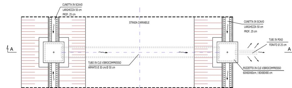
SEZIONE TIPO CON TUBO DI SCOLO Ø30/Ø50
