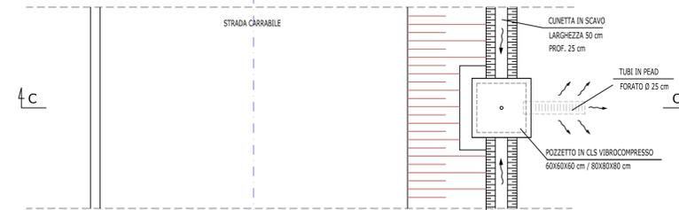
SEZIONE TIPO CON TUBO DI ATTRAVERSAMENTO Ø100
