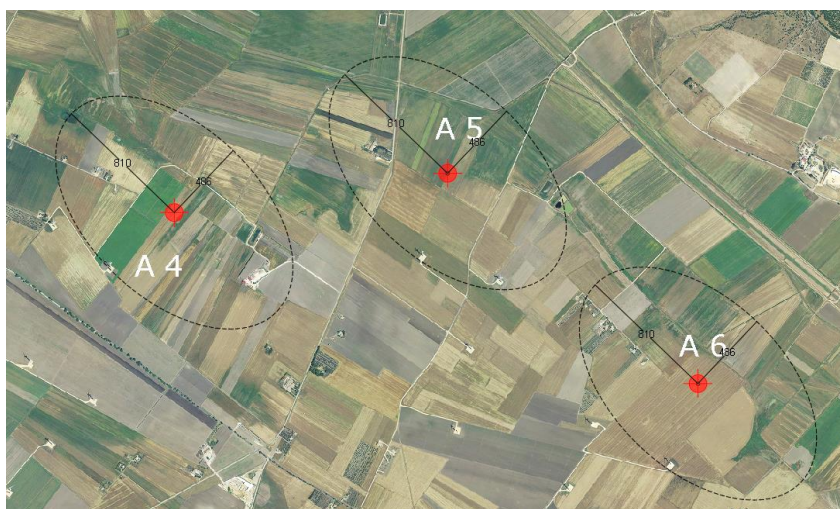
figura 7: schema del layout di progetto con indicazione delle interdistanze tra gli aerogeneratori.
