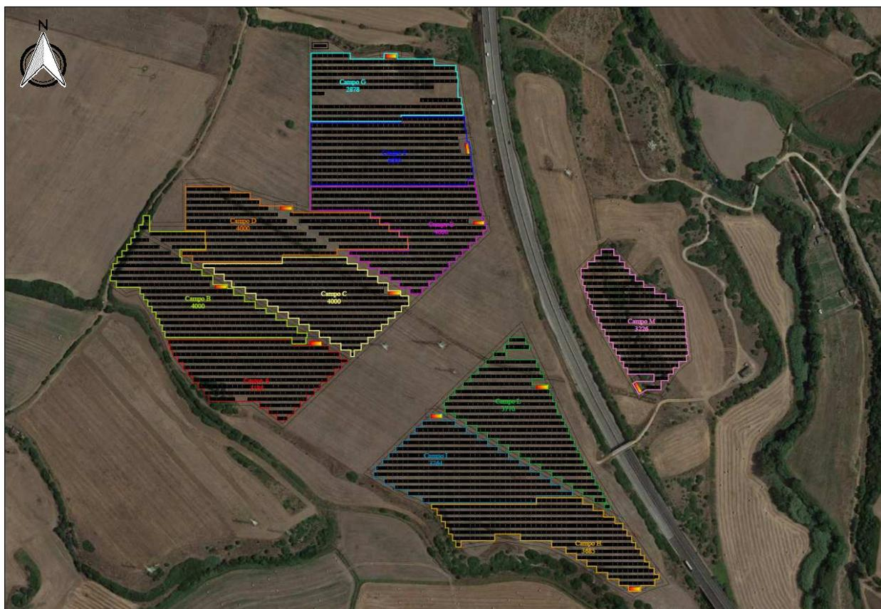
Figura 11.1 Layout dell’impianto fotovoltaico
