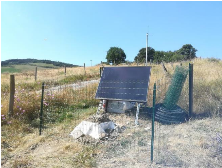
Figura 2.1.2.b Allestimento finale di una Stazione di Rilevamento Sismico
