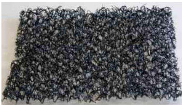
**Figura 5-2: Esempio di struttura di geostuoia**
