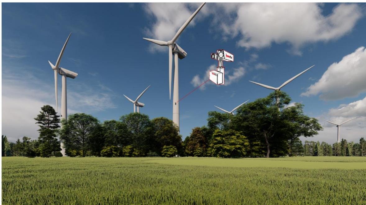
**Figura 9-6: Sistema di Monitoraggio on Termocamere da installare sulla torre delle turbine**
