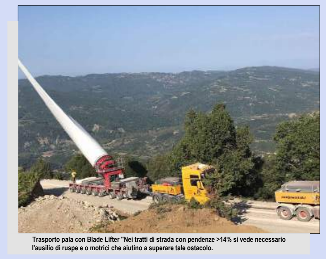
Trasporto pala con Blade Lifter "Le pale saranno opportunamente stoccate in area preposta e successivamente trasportate in sito".
