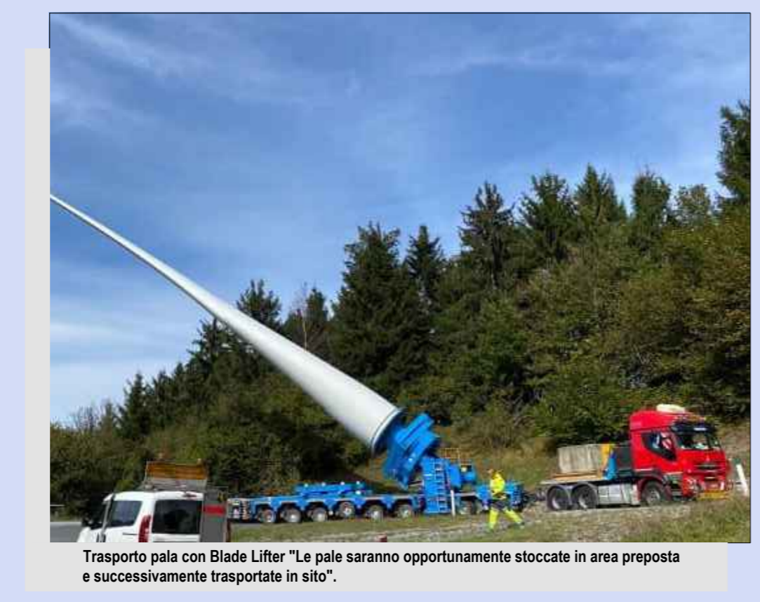
Trasporto pala con Blade Lifter "Le pale saranno opportunamente stoccate in area preposta e successivamente trasportate in sito".
