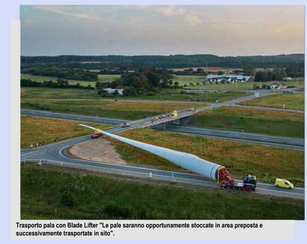
Trasporto pala con Blade Lifter "Le pale saranno opportunamente stoccate in area preposta e successivamente trasportate in sito".
