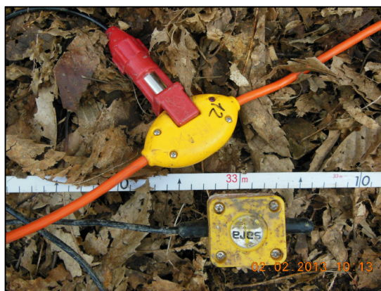
FOTO 5: geofono 12 a 33 m
