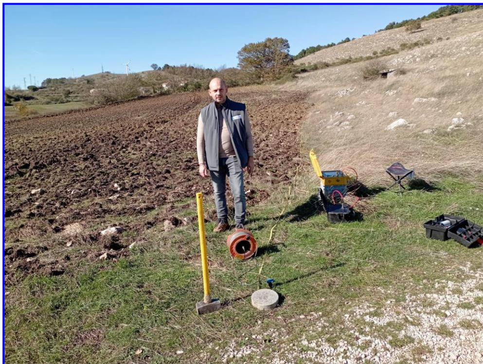
**Figura 1 - Prospezione sismica MASW n.4 effettuata in area progettuale.**
