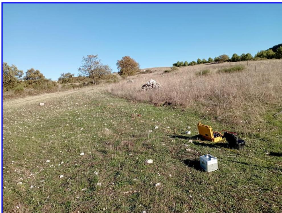
Figura 1 - Prospezione sismica MASW n.1 effettuata in area progettuale.
