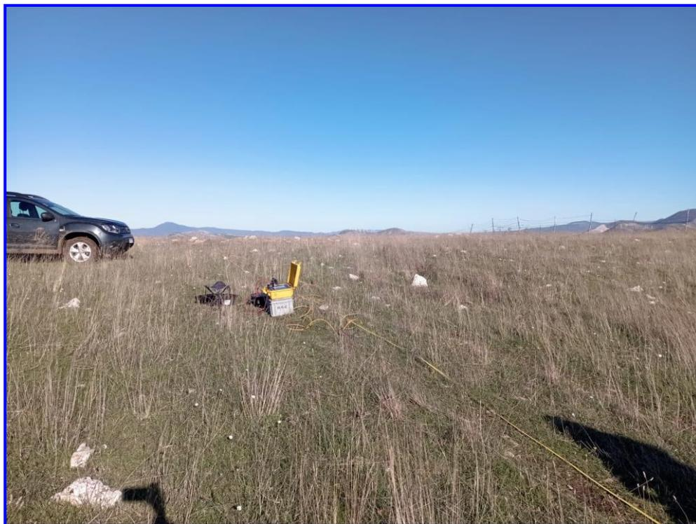
Figura 1 - Prospezione sismica MASW n.6 effettuata in area progettuale.
