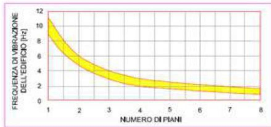
Figura 16 - Relazione tra numero di piani e frequenza di vibrazione dell'edificio
