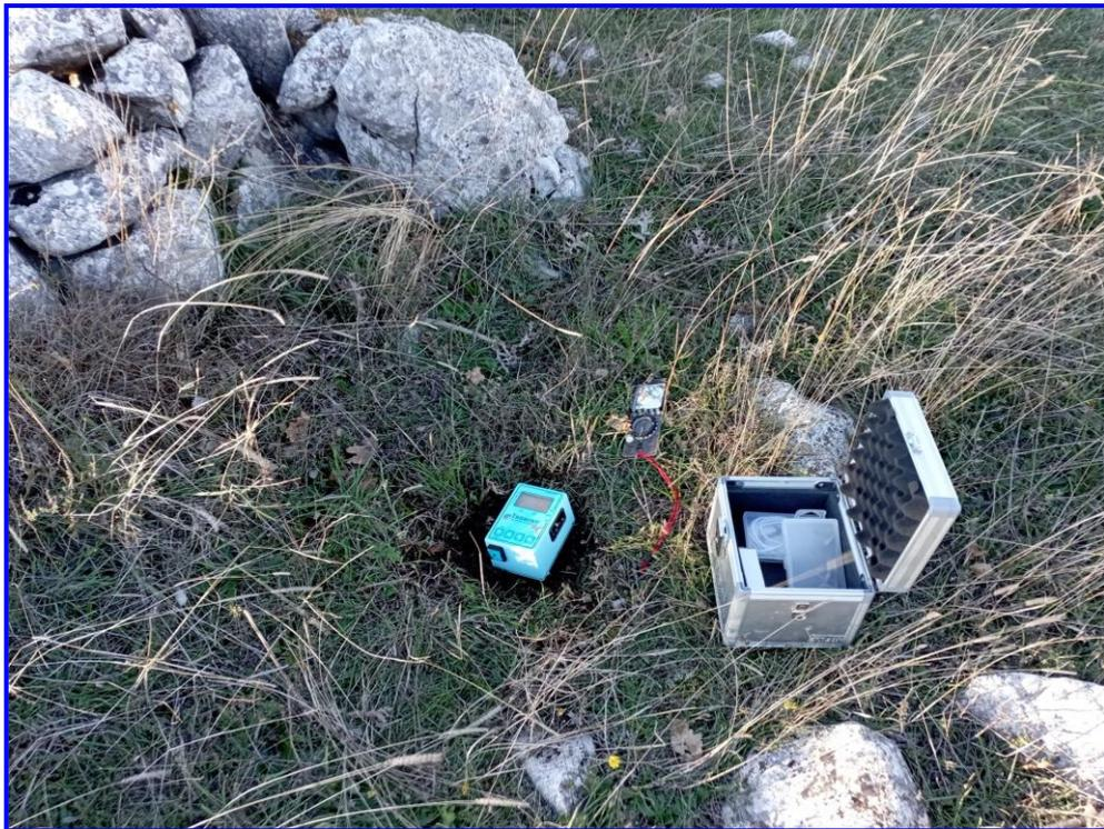
Figura 1 - Prospezione a sismica passiva HVSR n. 2 effettuata sul sito di interesse progettuale.
