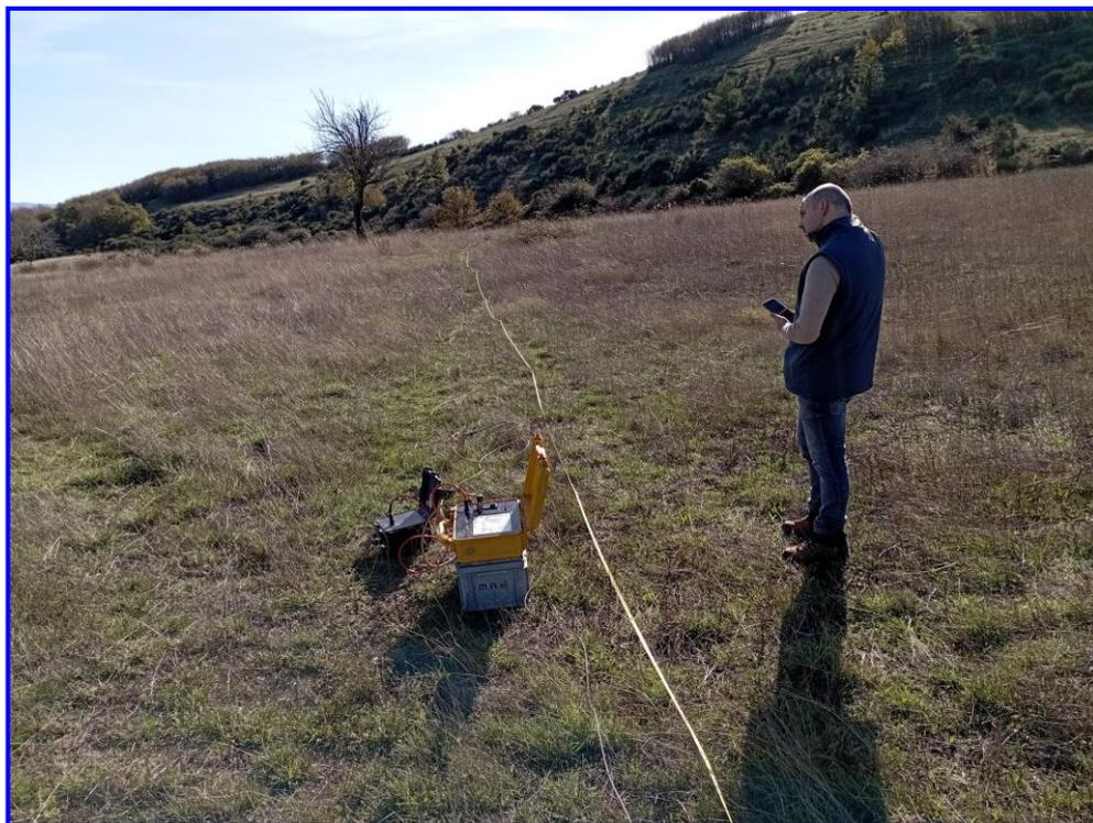
Figura 1 - Prospezione sismica MASW n.3 effettuata in area progettuale.
