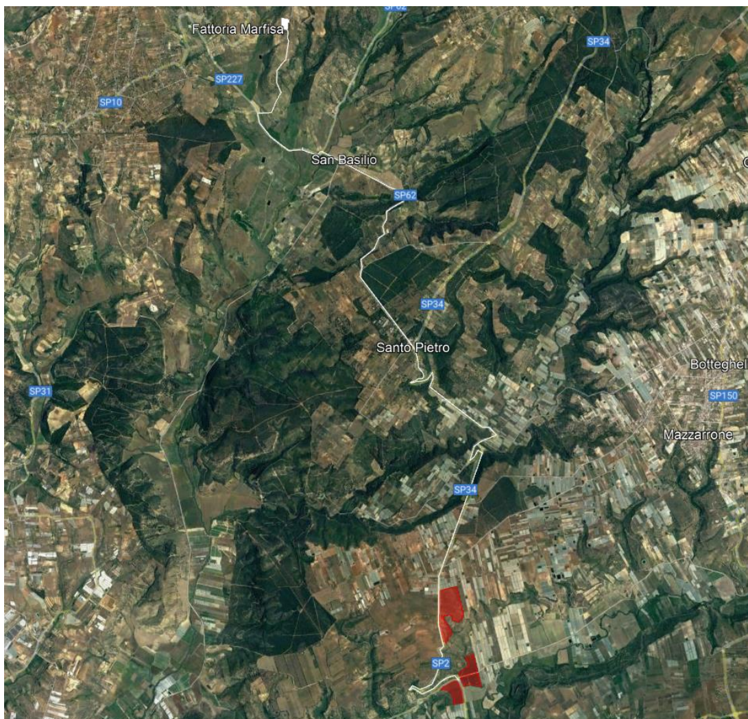
Figura 4 Area impianto fotovoltaico, cavidotto interrato e area stazioni elettriche su IGM (elaborazione interna)
