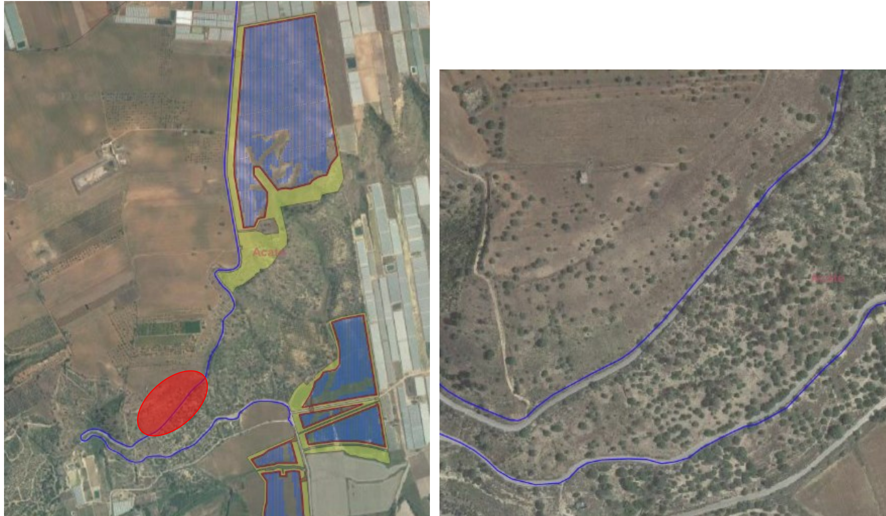
Figura 38. Interferenza (in rosso) del cavidotto MT (blu) sul vincolo paesaggistico (Foto Google Earth)
