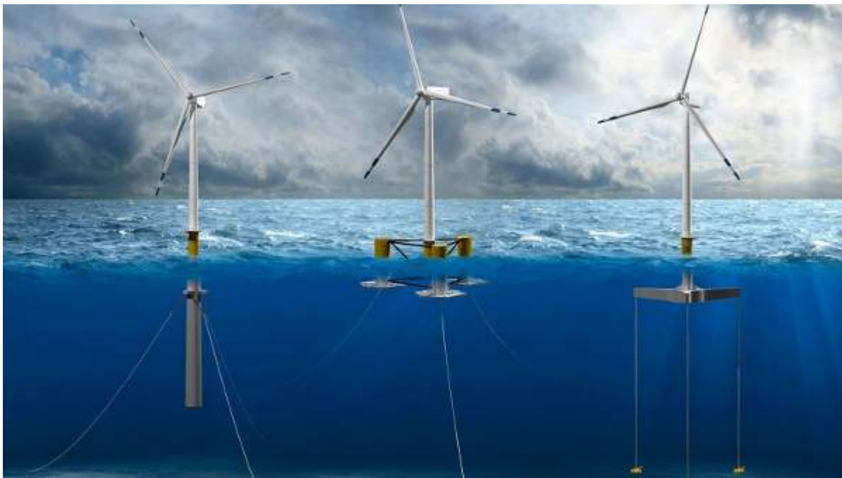
Figura 5 - Principali sistemi di ancoraggio
