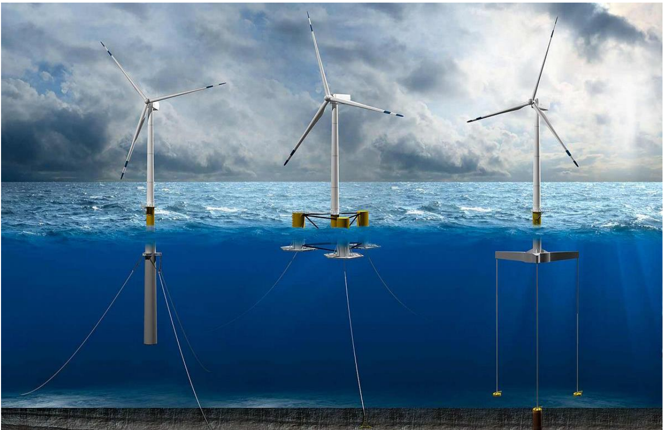
Figura 10 - Diverse tipologie di strutture galleggianti
