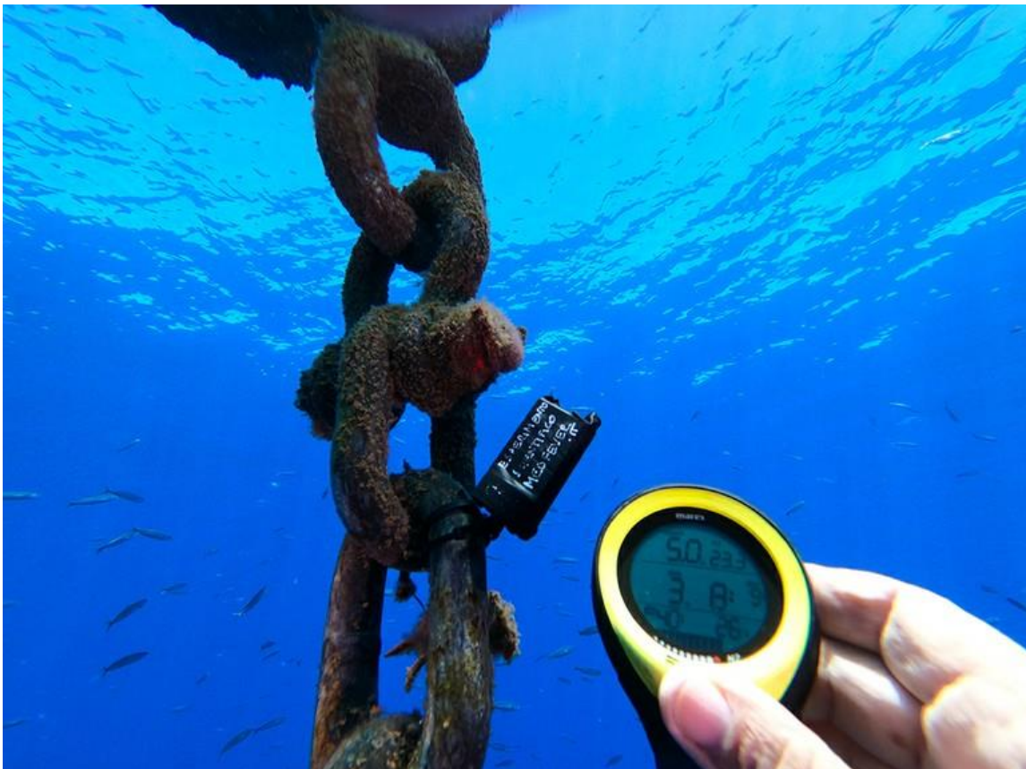
Figura 119 – Sensore-termometro fissato a una catena di ancoraggio per il monitoraggio della temperatura
