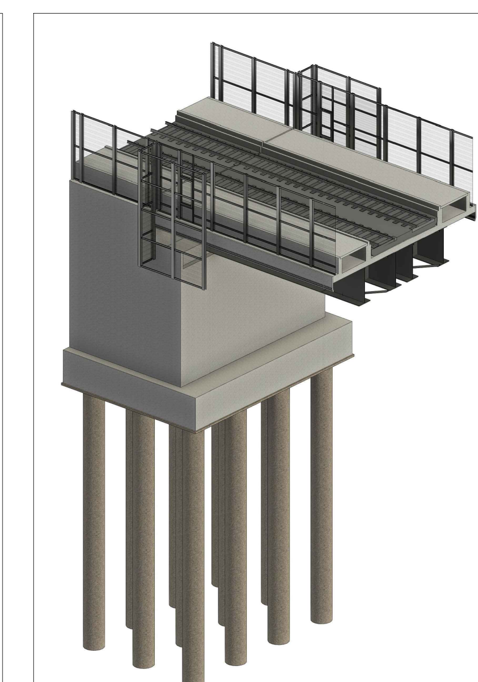
VISTA ASSONOMETRICA SPALLA B
