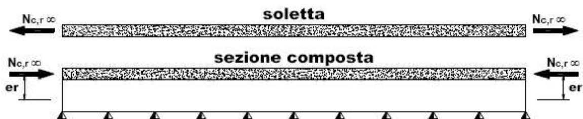
Figura 4.1:- Azioni statiche equivalenti al ritiro
