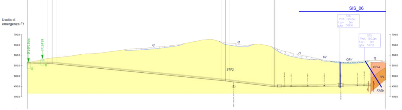
Figura 5. Profilo geologico - geotecnico longitudinale della finestra F1.
