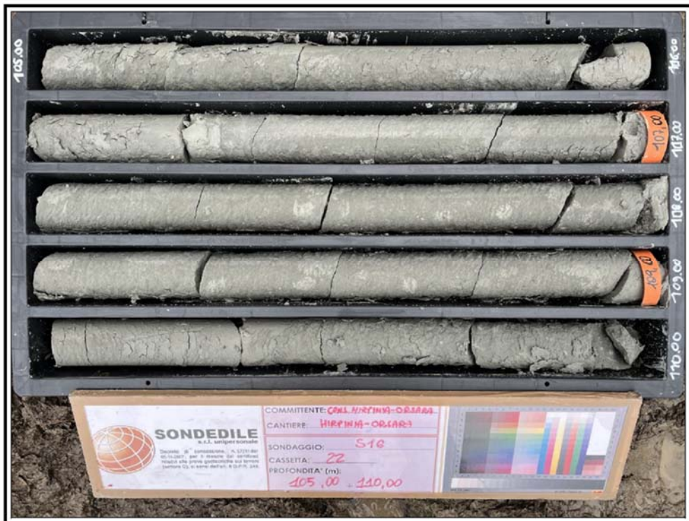
Figura 6 – Sondaggio S16, Carote prelevate a quota cavo relative alla formazione STF2.
