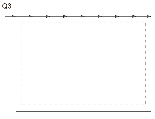
Carico frenatura/accelerazione in copertura (Q3)
