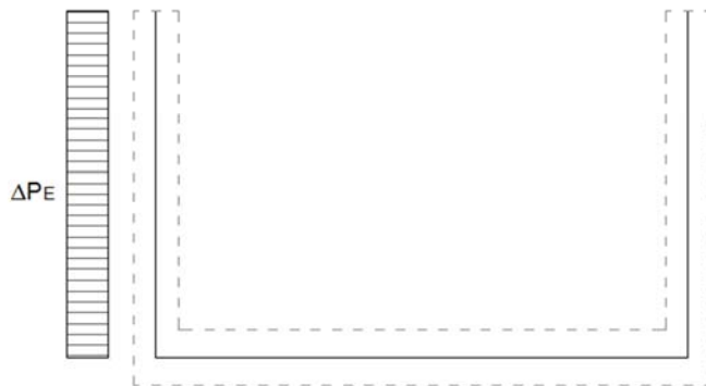
Sovraspinta terreno in fase sismica - Wood (SPS_H)
