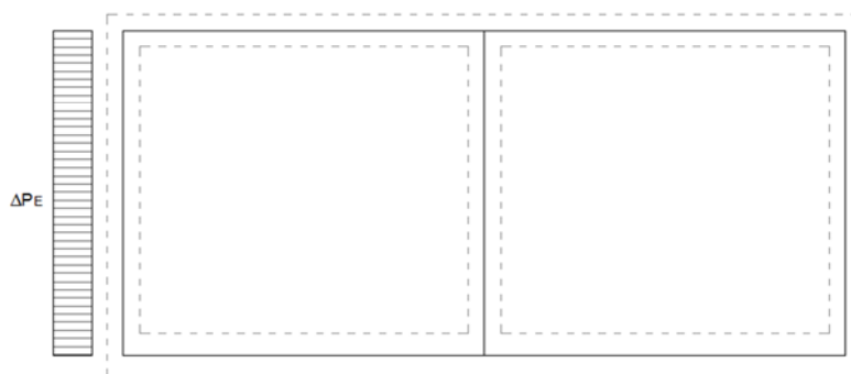
Sovraspinta terreno in fase sismica - Wood (SPS_H)
