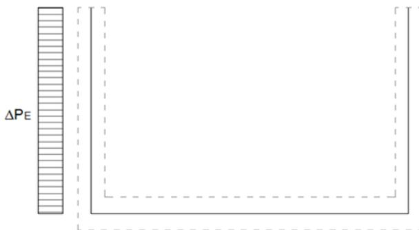
Sovrappinta terreno in fase sismica - Wood (SPS\_H)
