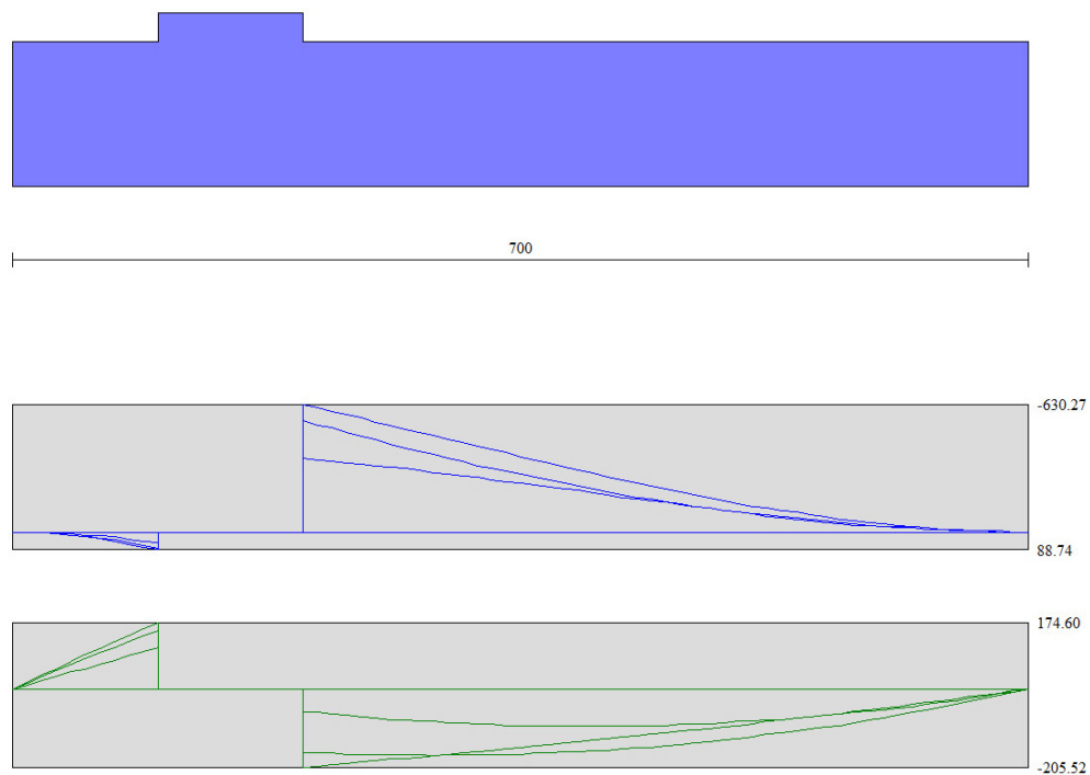
Figura 9-19. Involuppo delle sollecitazioni SLU e SLV sulla ciabatta di fondazione
