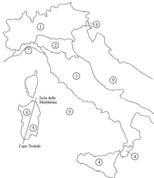
Fig. 18 – mappa delle zone in cui è diviso il territorio italiano per l'azione del vento – D.M.2018
