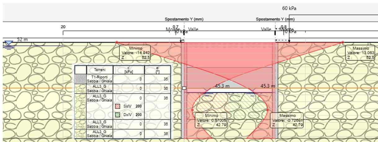
**Figura 10-1 Paratia di pali Spalla B – Spostamenti – Fase 5 (SLE) (falda a 352)**
