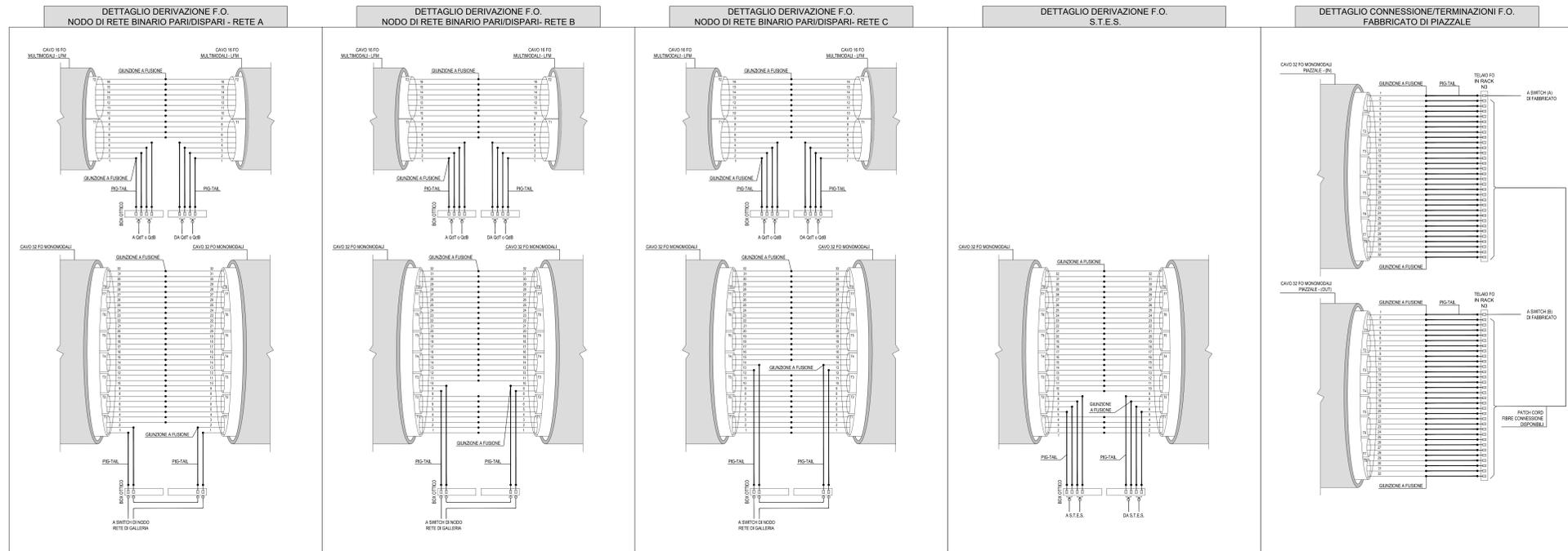
**UTILIZZAZIONE FIBRE OTTICHE CAVO 32 FIBRE MONOMODALI - RETE IN GALLERIA**
