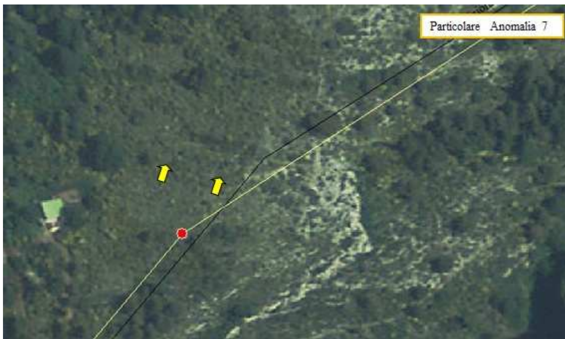
Figura 23 - Stralcio del fotopiano con le tracce riscontrate, qui evidenziate con frecce gialle. Il punto di colore rosso nell'immagine indica la posizione del nuovo sostegno.
