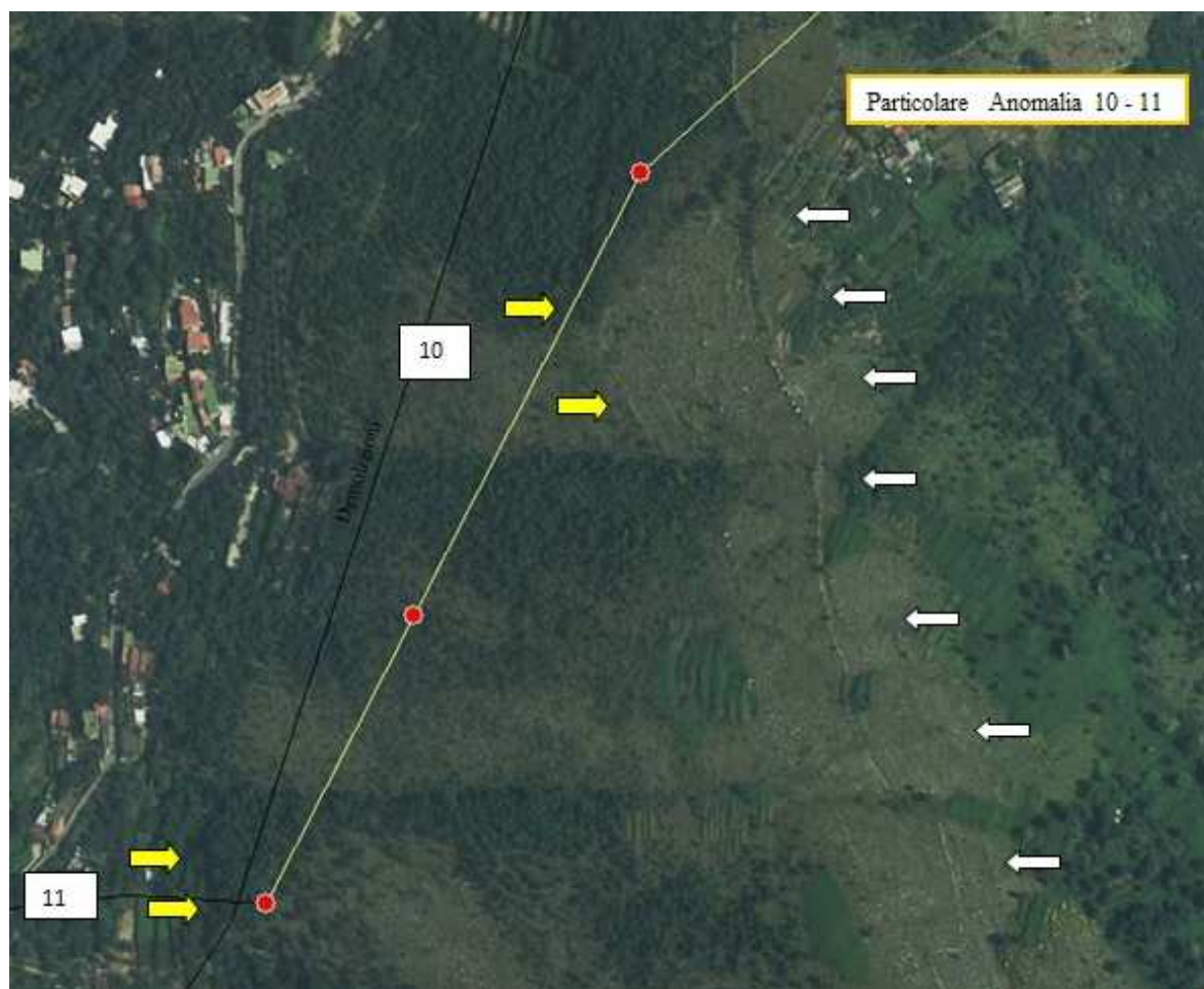
Figura 26 - Stralcio del fotopiano con le tracce riscontrate, qui evidenziate con frecce gialle. I punti di colore rosso nell'immagine indicano la posizione dei nuovi sostegni
