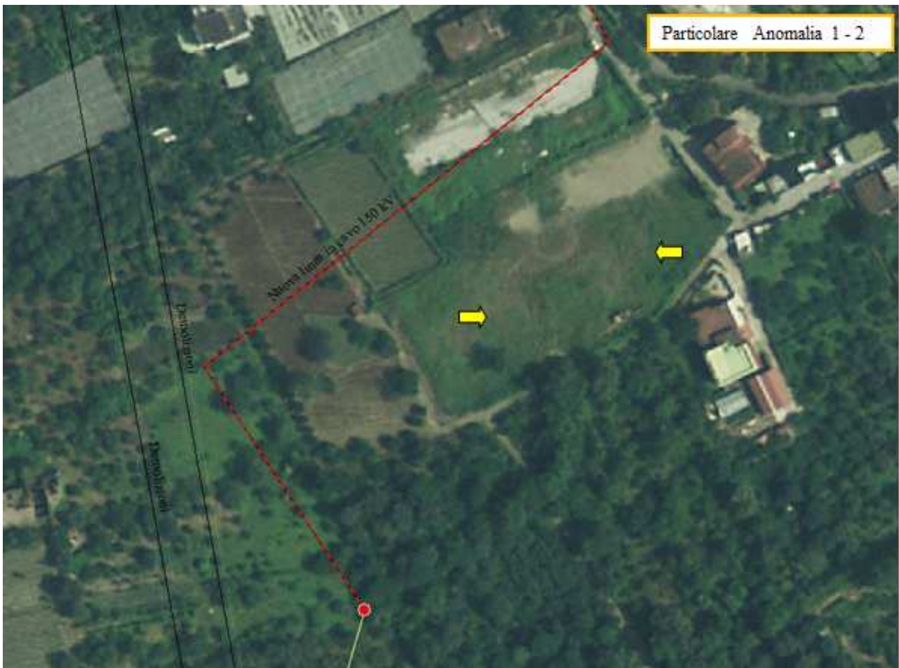
Figura 18 - Stralcio del fotopiano con le tracce riscontrate, qui evidenziate con frecce gialle. Il punto di colore rosso nell'immagine indica la posizione del nuovo sostegno.
