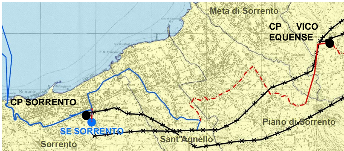
Figura 3: Collegamento misto aereo/cavo Sorrento - Vico Equense
