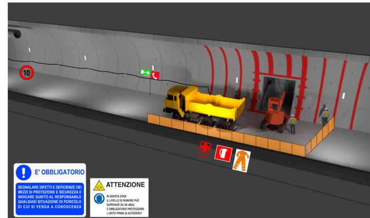
FASE 7 RIMOZIONE DEL PIANO DI LAVORO E RIMOZIONE DELLA CENTINATURA DI CONTRASTO
