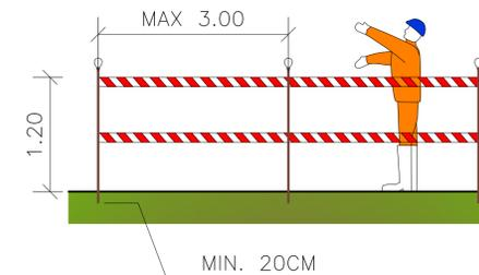
Nastro segnaletico per delimitazione di zone di lavoro, percorsi obbligati, aree inaccessibili, cigli di scavi, ecc, di colore bianco/rosso, fornito e posto in opera. Sono compresi: la fornitura degli spezzoni di ferro, ad interesse massimo di 3 metri, dell'altezza di cm 120 di cui almeno cm 20 da infiggere nel terreno a cui ancorare il nastro.
