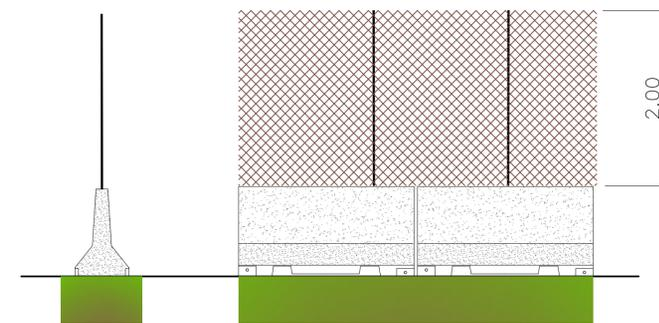
Delimitazione provvisoria per la protezione di zone di lavoro in cantieri stradali realizzata mediante barriere prefabbricate tipo New-Jersey, realizzate con calcestruzzo armato, integrata con sovrastante recinzione in rete metallica, maglia 50 x 50 mm, in filo di ferro zincato, diametro 2 mm, di altezza 2 m ancorata a pali di sostegno in profilato metallico a T, sezione 50 mm.
