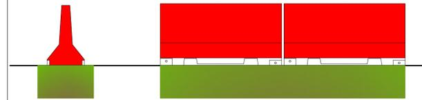
Delimitazione provvisoria per la protezione di zone di lavoro in cantieri stradali realizzata mediante barriere prefabbricate tipo New-Jersey, in calcestruzzo armato
