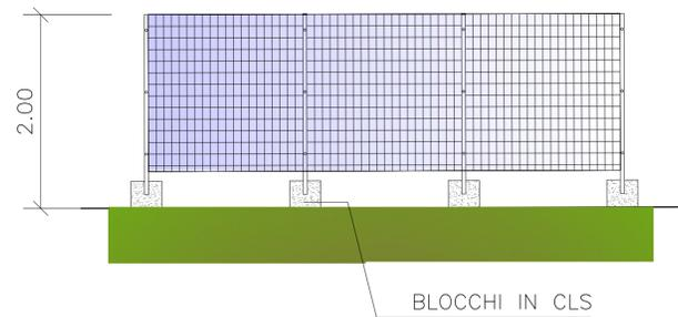
Recinzione provvisoria modulare da cantiere, costituita da pannelli metallici di rete elettrosaldata fissati a terra su basi prefabbricate in calcestruzzo.
