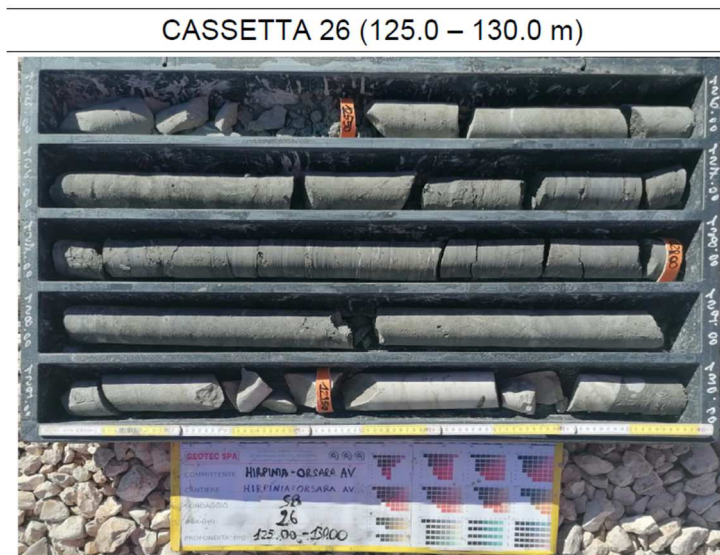
Figura 11-3 – Carote prelevate nella litofacies FAEm, sondaggio S08.
