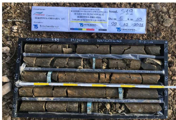
Figura 11-124 – Carote prelevate relative alla formazione BNA2, sondaggio S19.
