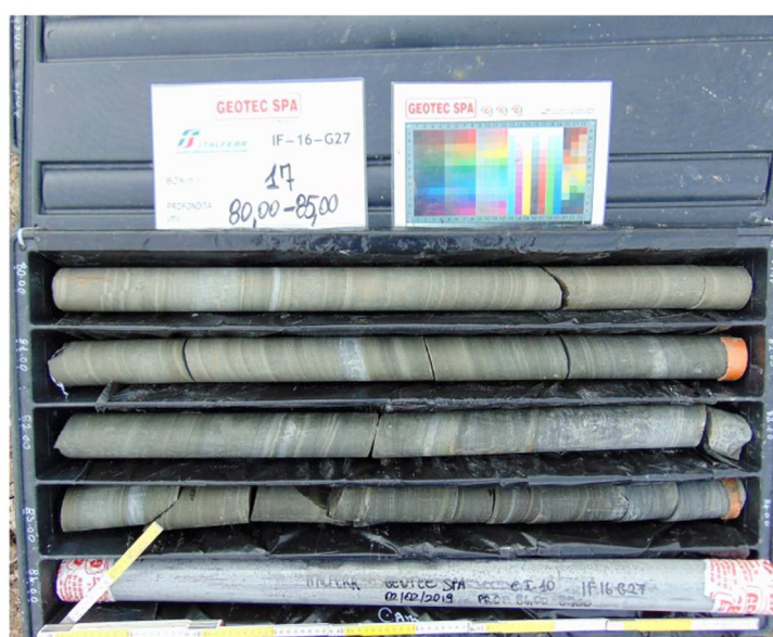
Figura 11-49 – Carote relative alla formazione TPC, sondaggio IF16G27.
