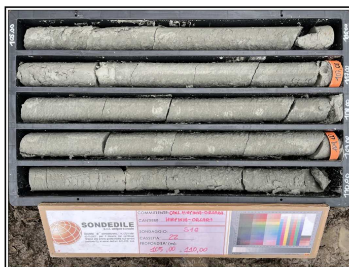
Figura 11-106 – Carote prelevate a quota cavo relative alla formazione STF2, sondaggio S16.
