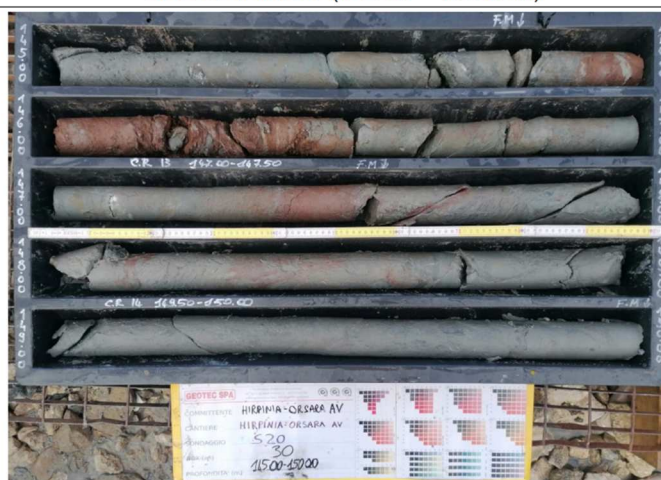
Figura 11-142 – Carote prelevate a quota cavo relative alla formazione ANZ2, sondaggio S20.
