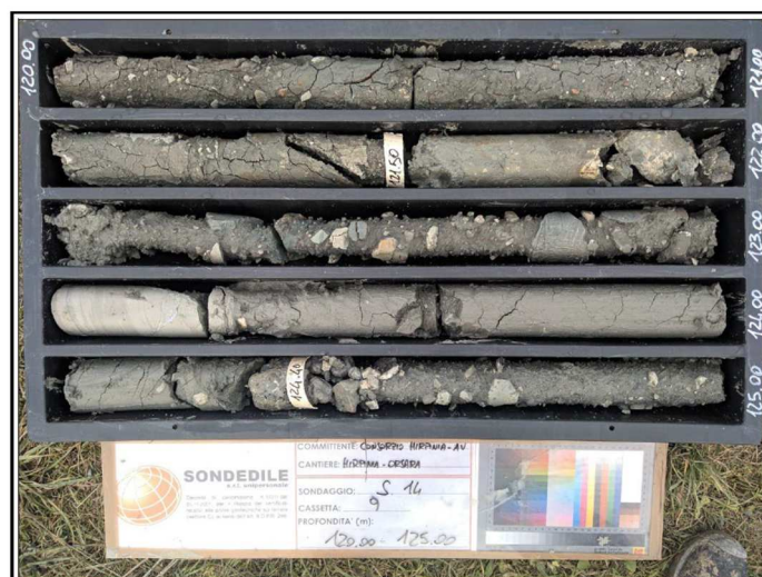
Figura 11-96 – Carote prelevate relative alla formazione CTLa, sondaggio S14.
