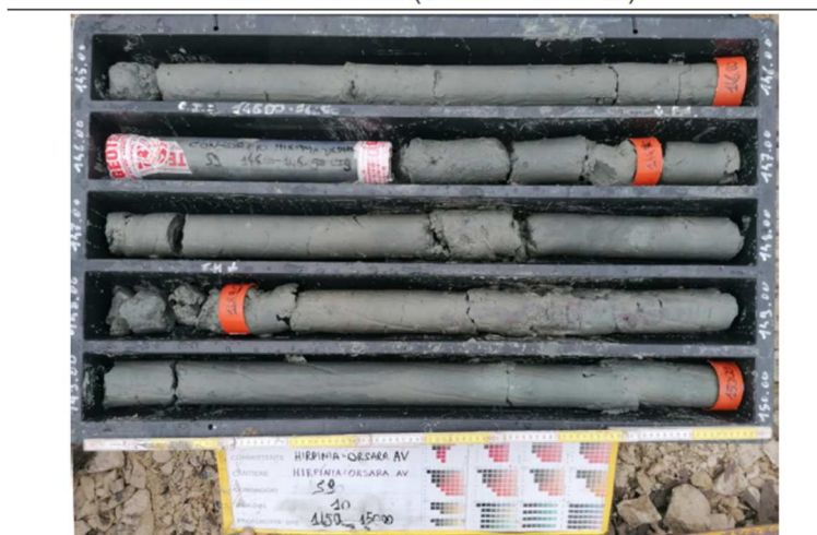
Figura 11-55 – Carote prelevate a quota cavo relative alla formazione FYR, sondaggio S9.
