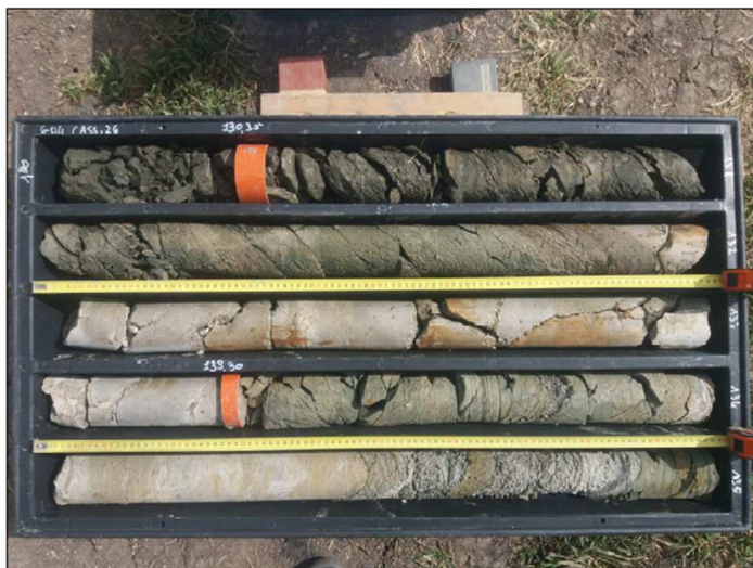
Figura 11-1 – Carote prelevate nella litofacies FAEam, sondaggio IF16G04.
