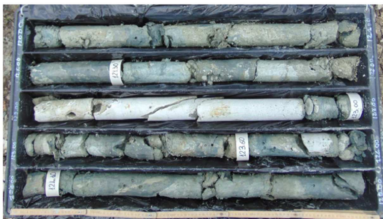
Figura 11-2 – Carote prelevate nella litofacies FAEm, sondaggio IF16G07.
