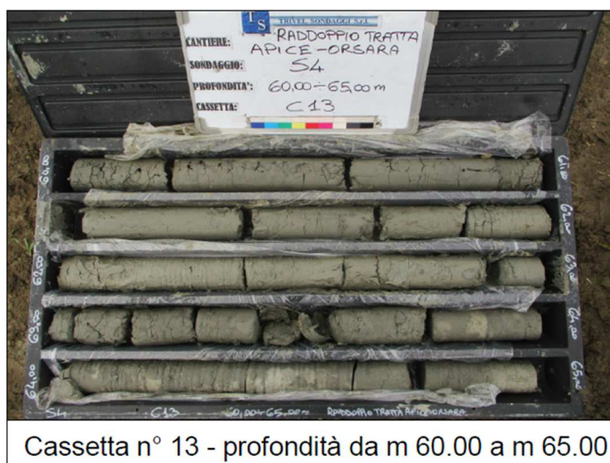
Figura 11-29 – Carote prelevate a quota cavo relative alla formazione BVNb, sondaggio S4.
