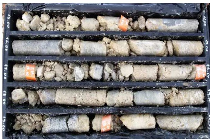
Figura 11-95 – Carote prelevate relative alla formazione CTLa, sondaggio F16G32, tra 25 e 30 m da p.c.
