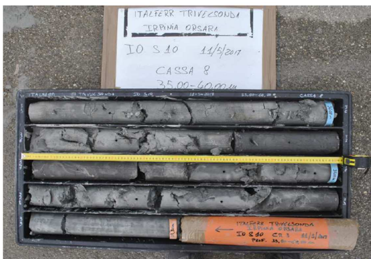
Figura 11-159 – Carote prelevate a quota cavo relative alla formazione TFR, sondaggio IO-S10.
