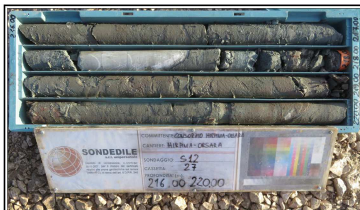
Figura 11-56 – Carote prelevate a quota cavo relative alla formazione FYR, sondaggio S12.
