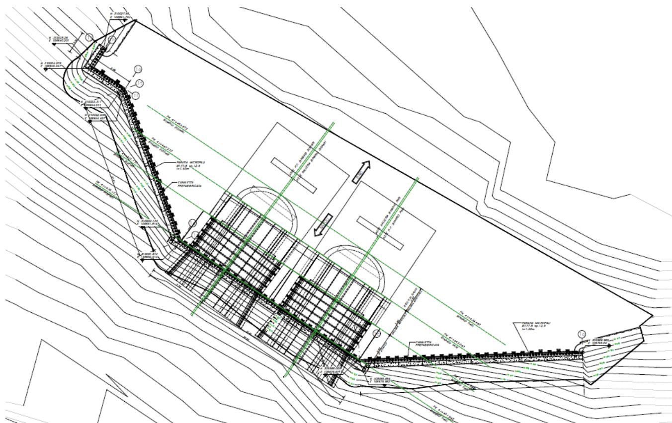
Figura 3-2: Planimetria delle opere di imbocco della galleria Hirpinia lato Bari – Fase provvisoria
