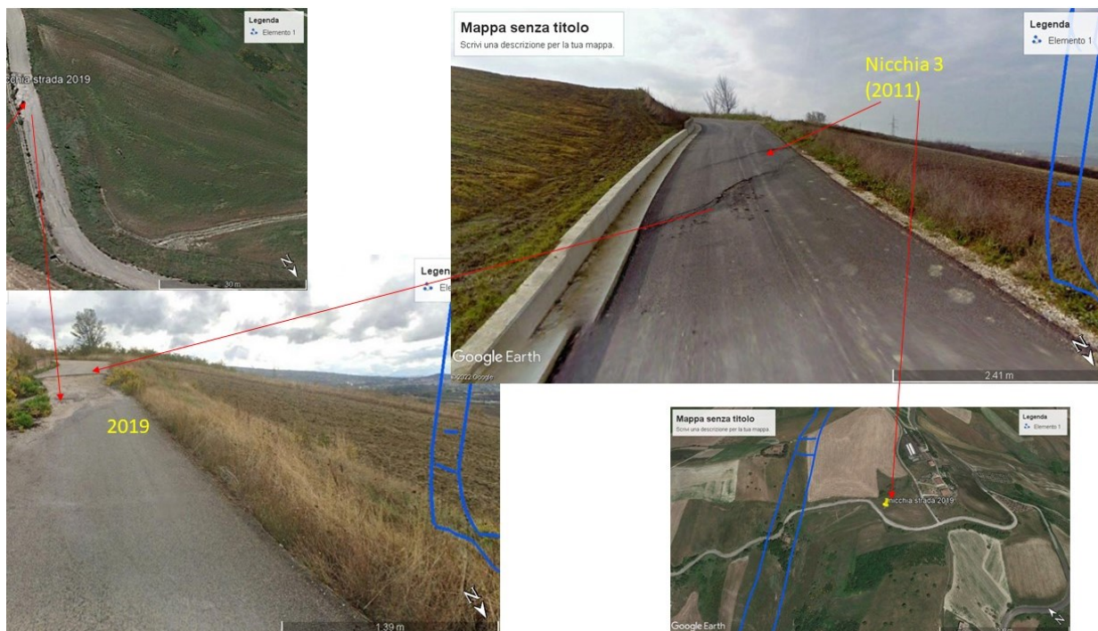
Figura 2-29 - Riattivazione recenti della nicchia di frana 3 di Figura 2-27 evidenziate da lesioni sulla strada.
