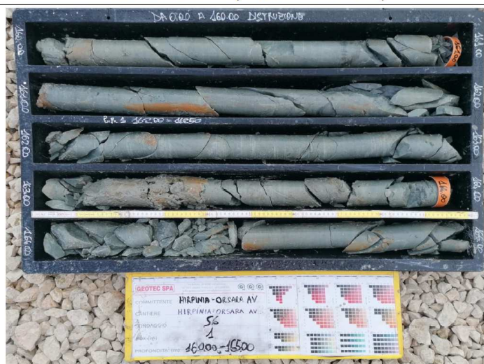
Figura 10-50 - Carote relative alla formazione TPC, sondaggio S6.
