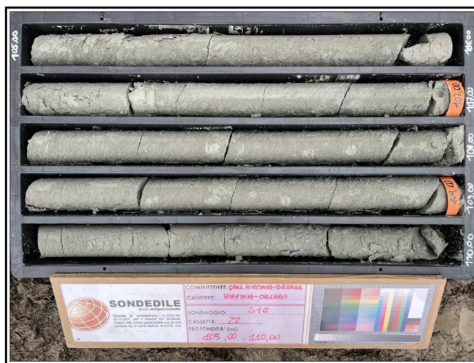
Figura 10-106 – Carote prelevate a quota cavo relative alla formazione STF2, sondaggio S16.
