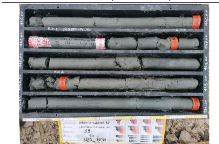
Figura 10-55 – Carote prelevate a quota cavo relative alla formazione FYR, sondaggio S9.
