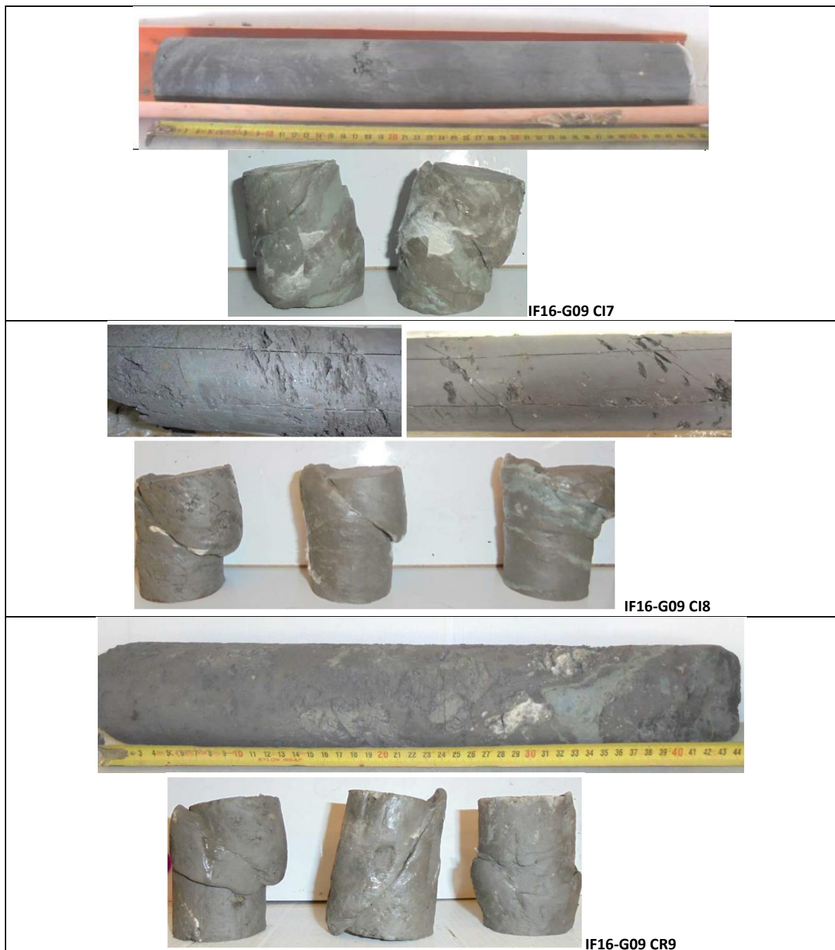
Figura 3. Foto di provini triassiali al termine delle prove TX-CIU
