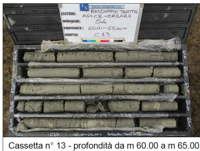
Figura 10-29 – Carote prelevate a quota cavo relative alla formazione BVNb, sondaggio S4.
