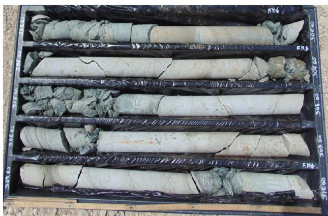
Figura 10-4 – Carote prelevate nella litofacies FAEc, sondaggio IF16G06.
