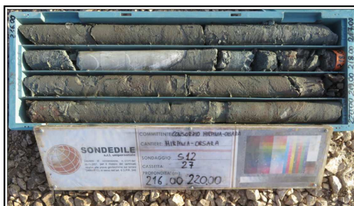
Figura 10-56 – Carote prelevate a quota cavo relative alla formazione FYR, sondaggio S12.
