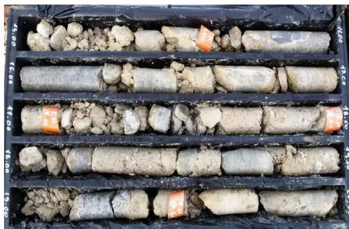
Figura 10-95 – Carote prelevate relative alla formazione CTLa, sondaggio F16G32, tra 25 e 30 m da p.c.
