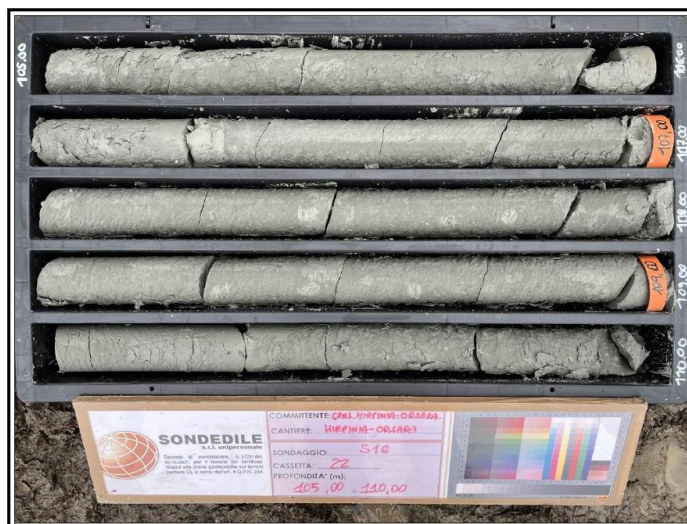
Figura 4-25. Sondaggio S16, Carote prelevate a quota cavo relative alla formazione STF2.
