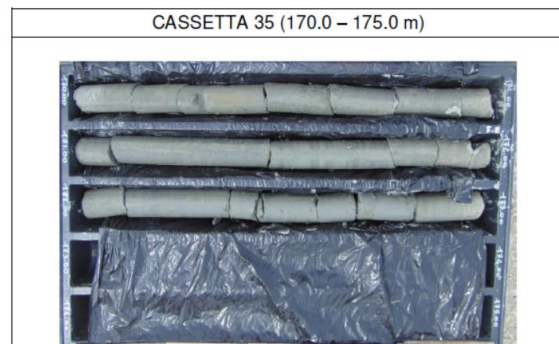
Figura 4-24. Sondaggio IF16G12, porzione rappresentativa della stratigrafia e fotografie delle carote alla profondità dell'opera.
