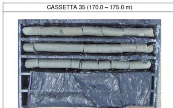
Figura 3-6. Sondaggio IF16G12, porzione rappresentativa della stratigrafia e fotografie delle carote alla profondità dell'opera.
