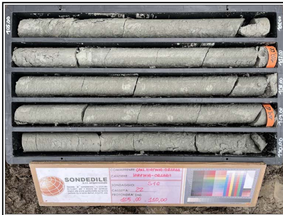
Figura 3-5 – Sondaggio S16, Carote prelevate a quota cavo relative alla formazione STF2.
