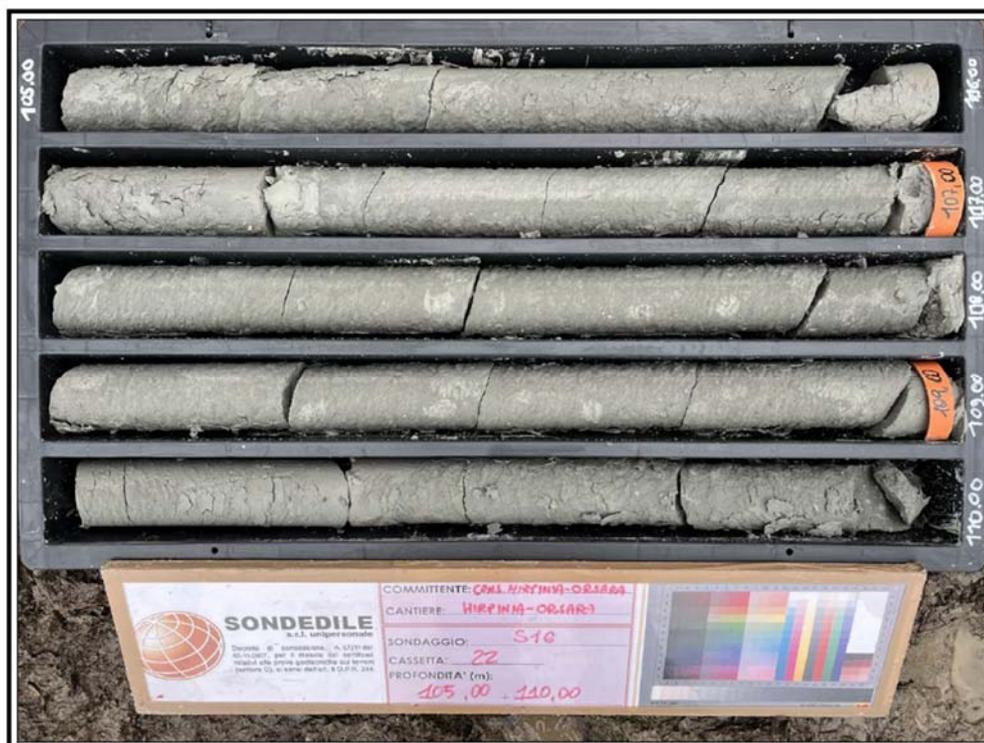
Figura 6-5 – Sondaggio S16, Carote prelevate a quota cavo relative alla formazione STF2.
