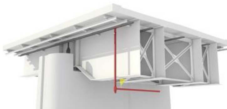
Figura 3-2. Robot di ispezione impalcato
