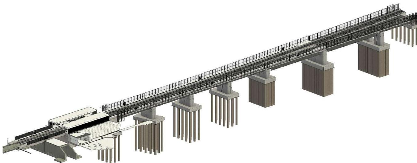
**Figura 9-57 : Vista di insieme Modello strutturale BIM – Viadotto Cervaro e Stazione di Orsara**
