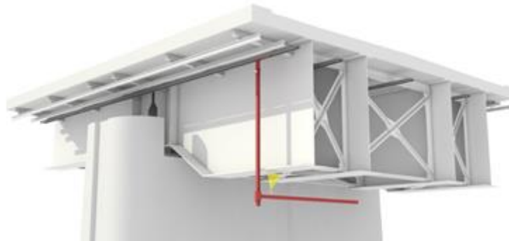
Figura 3-7. Robot di ispezione impalcati
