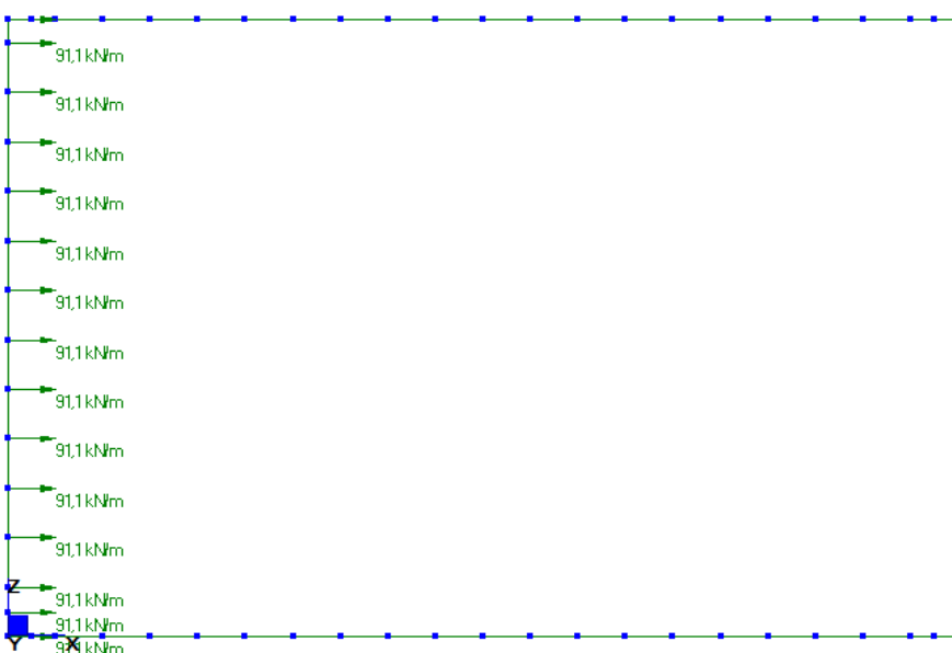
Figura 7-25: Azione variabili- Caso di carico: Ex_terreno_falda_min
