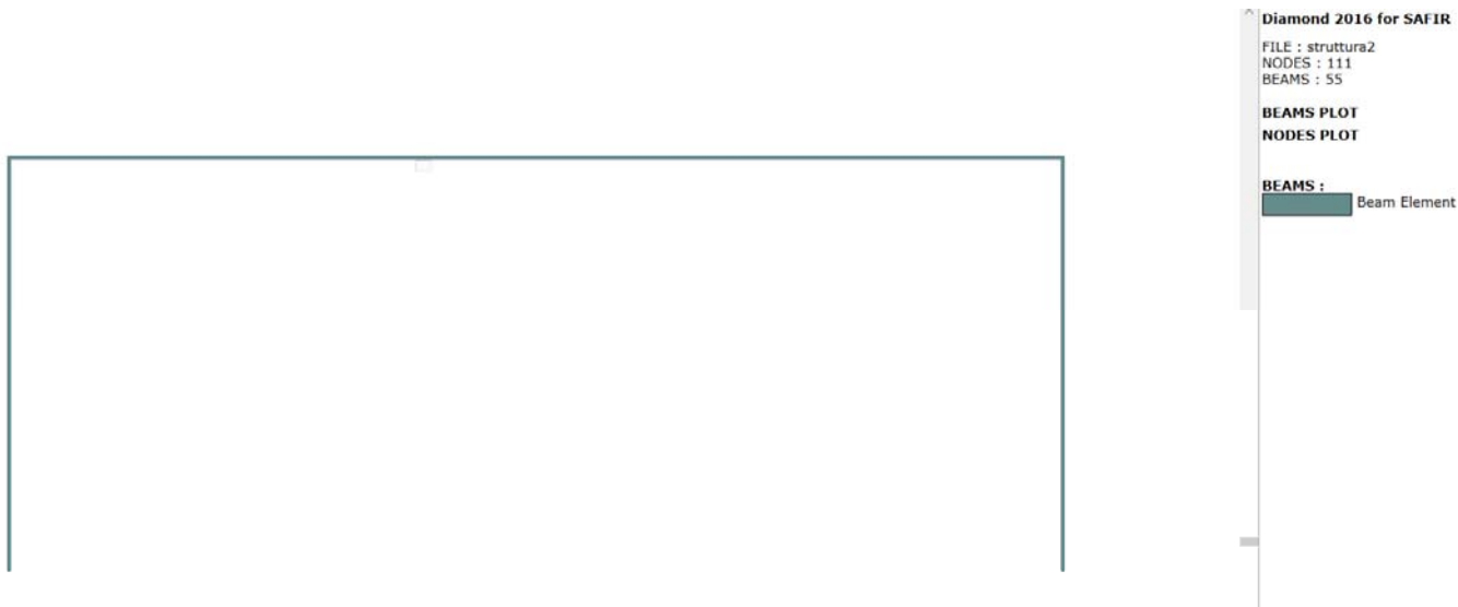
Figura 7-3 Sezione tunnel tipo 1 rappresentata tramite elementi 'beam'
