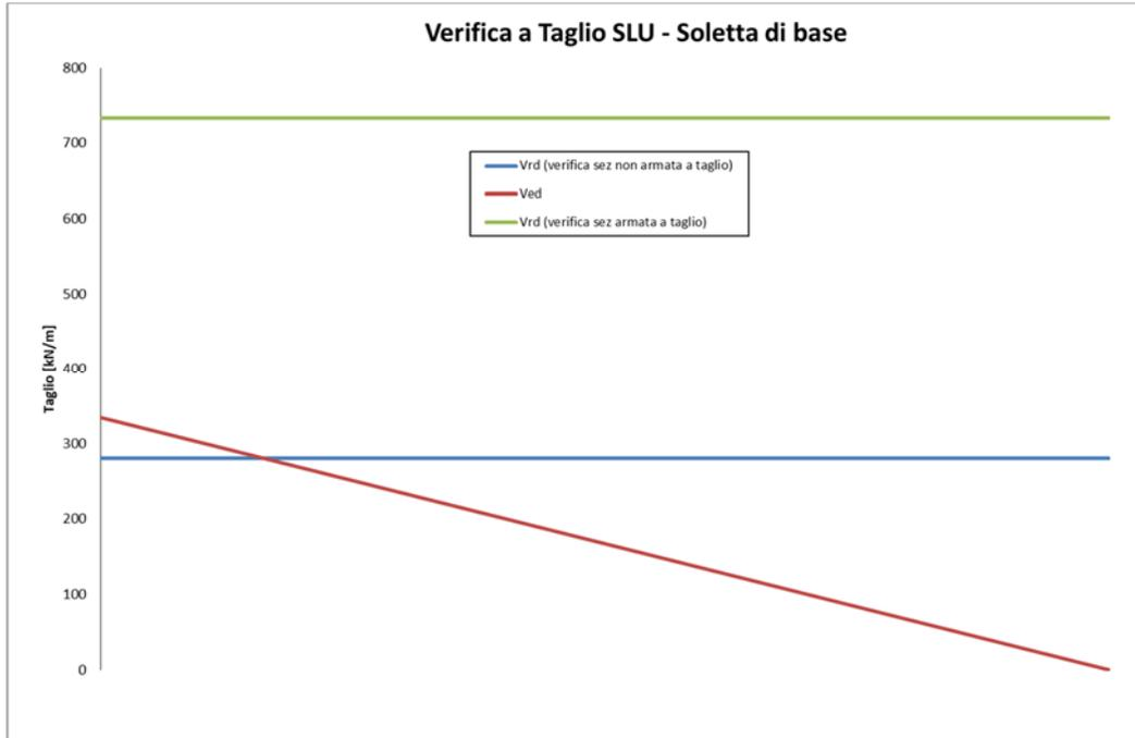
Figura 8-42. Verifica a taglio allo SLU soletta di base
