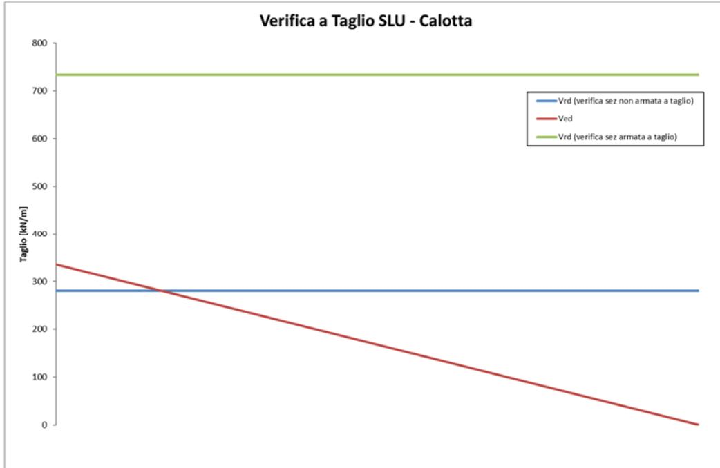
Figura 8-38. Verifica a taglio allo SLU in calotta
