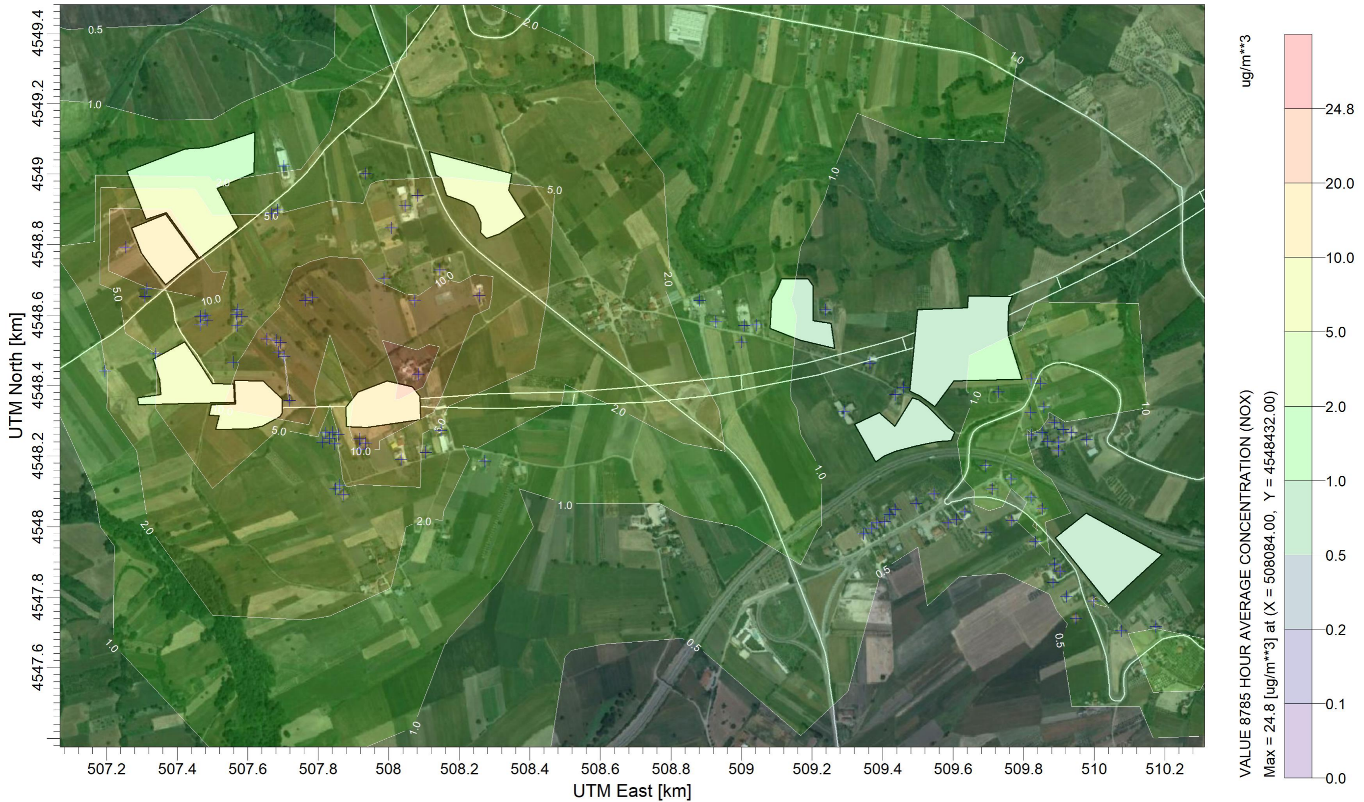
Figura 8-7. TBM galleria Hirpinia - lato Napoli. NOx media annuale
