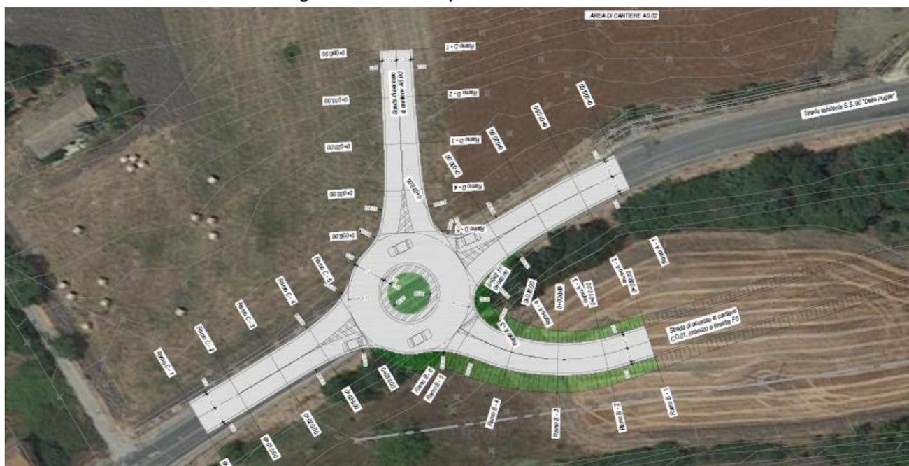
Figura 2-4 – Planimetria Rotatoria provvisoria su S.S. 90 per accesso alle aree di cantiere
