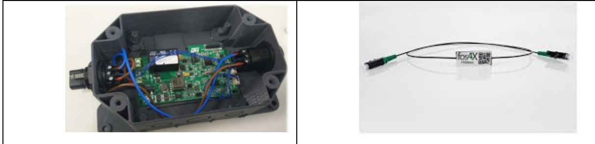
Figura 5.2. Accelerometri triassiali MEMS ed estensimetri a fibra ottica.
