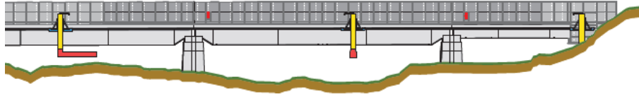
Figura 3.4. Sezione longitudinale 2/2: posizioni di lavoro di ogni singolo carrello mobile sull'intero sviluppo dell'impalcato.
