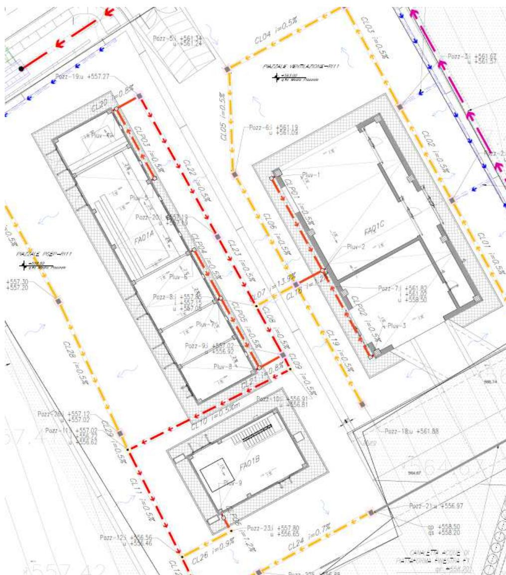
Figura 2-Stralcio planimetrico Rete di drenaggio piazzale RI11 – FA01A – FA01B – FA01C
