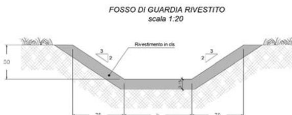
Figura 11: Sezione tipologica del fosso di guardia rivestito in CLS
