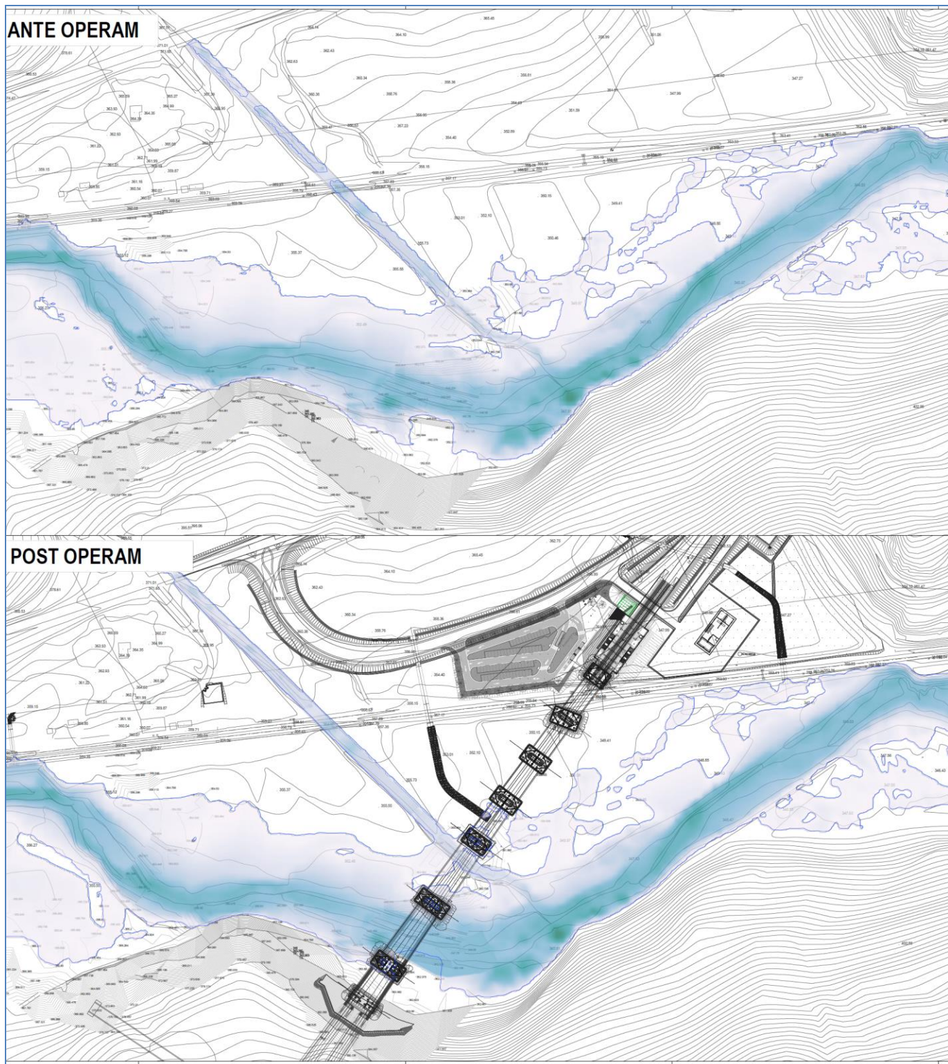
Figura 5-7 – Aree di allagamento espresse in battenti (m) ante operam (in alto) e post operam (in basso) per TR 500 anni.
