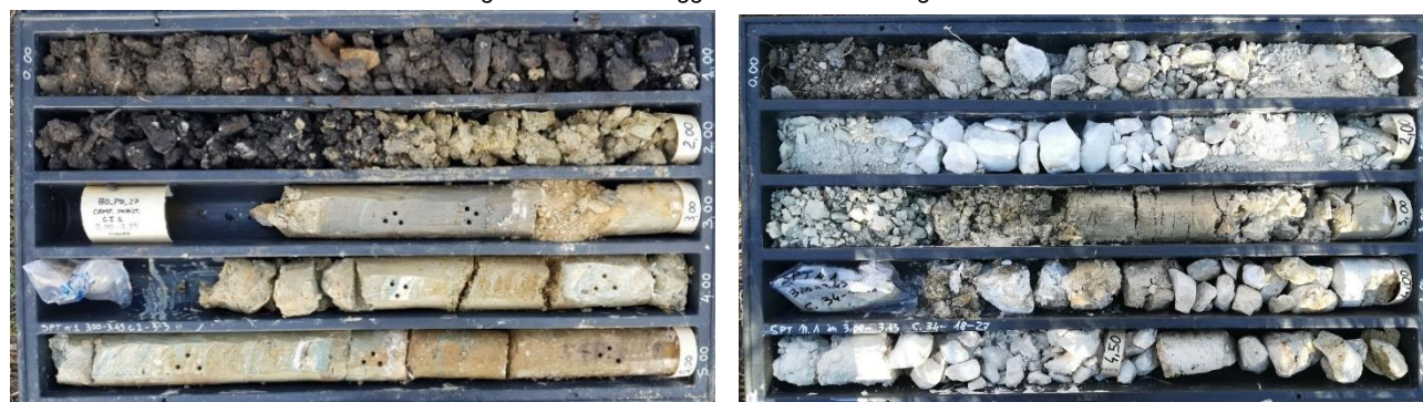
Figura 4-11 – Materiale alla profondità 0 - 5 m: a) Sondaggio BO-PD-S27, b) Sondaggio BO-PD-S28.
