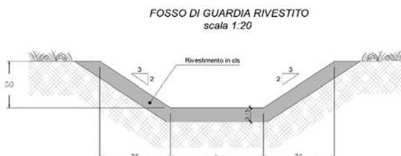
Figura 7: Sezione tipologica del fosso di guardia rivestito in CLS
