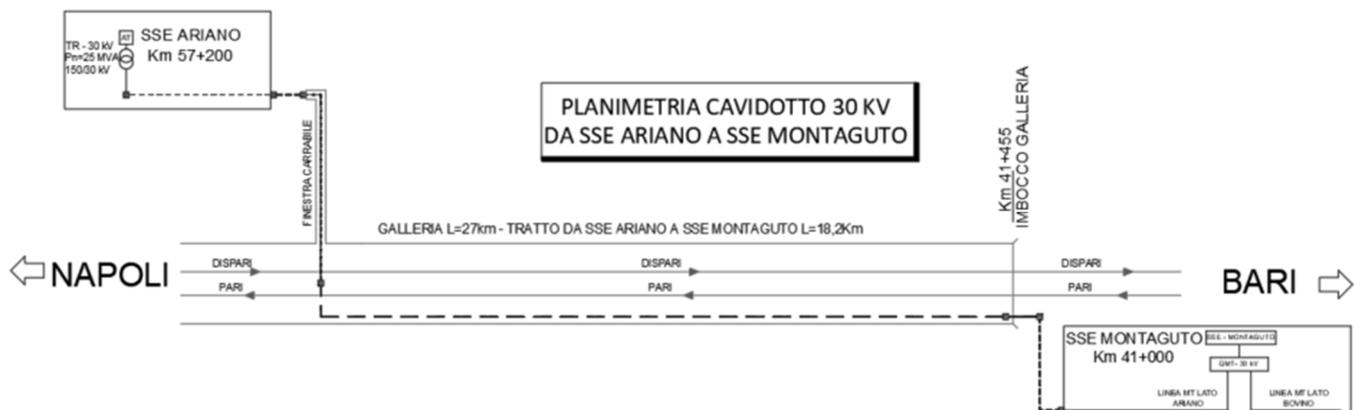
Il collegamento verrà realizzato con cavo tipo: CPR di classe B2ca-s1a, d1, a1, 18-30kV sez. 3x1x400mm<sup>2</sup>.
