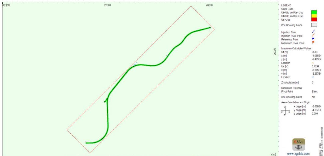
Figura A1-6 – Rappresentazione delle aree sicure sulla superficie del terreno (impianto di terra complessivo)
