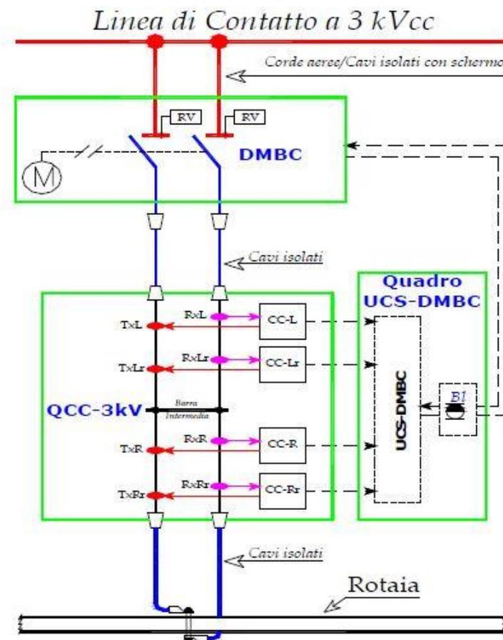
Per consentire il corretto funzionamento del QCC, il DMBC è provvisto di due lame delle medesime caratteristiche. Il DMBC a doppia lama viene collegato tramite due cavi di pari sezione, ed in grado di sostenere l'intera corrente di corto circuito, alla linea di alimentazione (LdC). I punti di collegamento alla linea/feeder devono essere disgiunti in modo che non esista la possibilità di distacco contemporaneo dei cavi dalla linea senza che si interrompa la continuità tra i cavi stessi.
